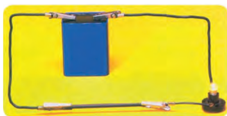
شکل ۳۵- مدار بررسی‌کننده هدایت الکتریکی مواد
